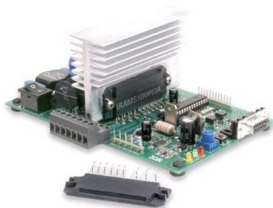
Slika 40. Realan izgled pretvarača IRADK 10 .
