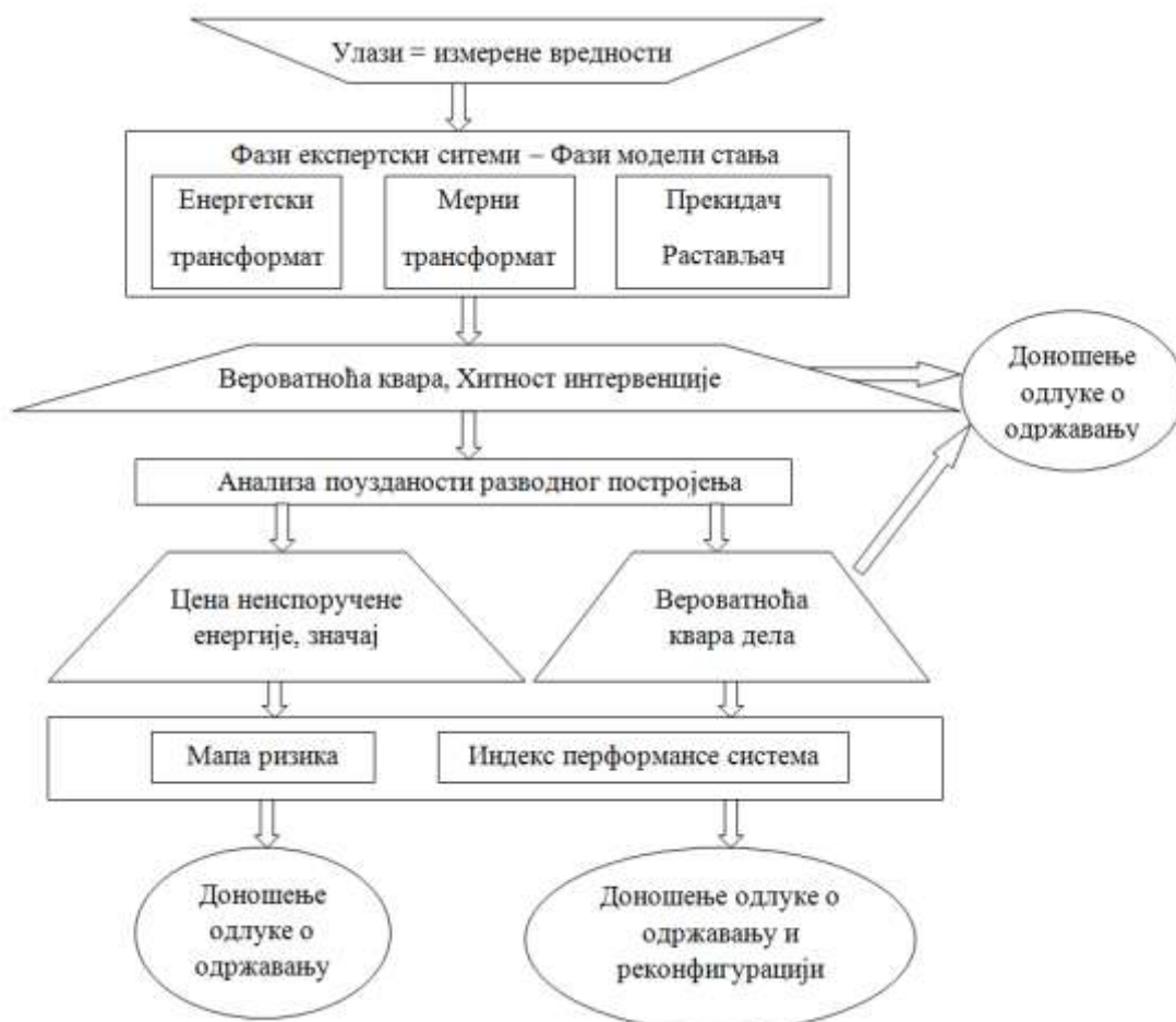
Сл. 3.1.1 Алгоритам методе за дијагностику стања и анализу поузданости на бази фази теорије
