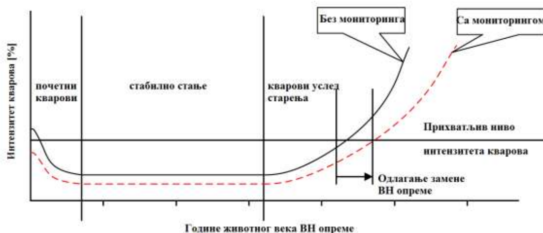
Сл. 2.1.1 Утицај одржавања високонапонске опреме са и без мониторинга на интензитет кварова [1]
