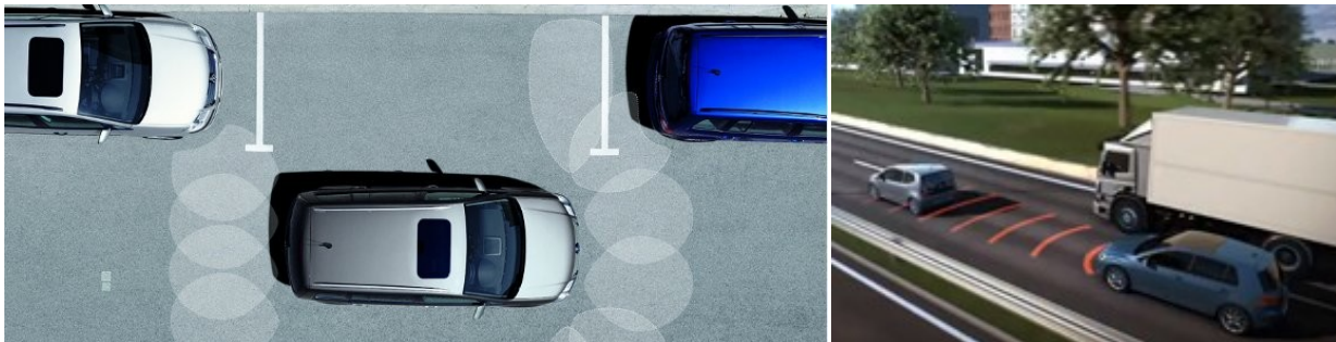
Sl. 76, Primer primene senzora rastojanja u automobilima. Slika je preuzeta sa sajta uz dozvolu i zahvalnost Volkswagen-u UK (With thanks to Volkswagen UK).
