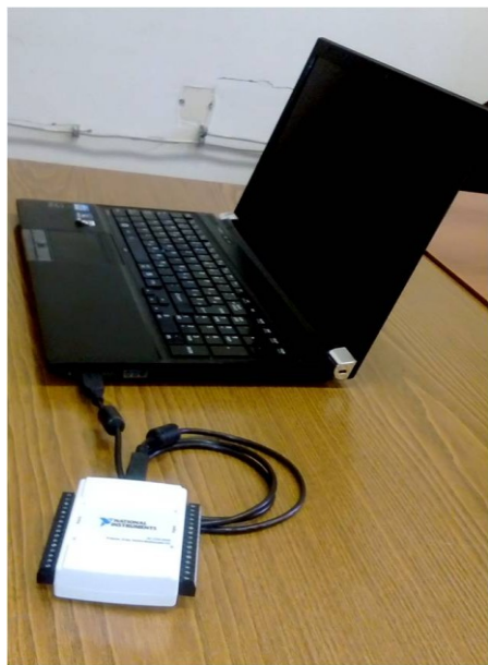
Sl. 114, Primer povezivanja A / D kartice USB NI 6008 ( National Instruments Inc. ) sa računarom preko USB porta za projektovanje virtualne instrumentacije.
