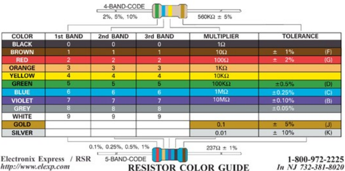
Sl. 10, Primer računanja otpornosti otpornika preko Color Code šeme. Na gornjem panelu je dat primer procenjene otpornosti otpornika od 560 kΩ, a na donjem panelu za otpornik otpornosti 237 Ω i njihove tolerancije na osnovu boja na otporniku. Courtesy of Electronix Express www.elexp.com (uz dozvolu od Electronix Express www.elexp.com ).
