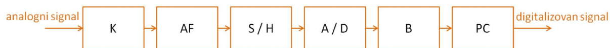
Sl. 59, Blok šema uređaja za merenje signala sa osnovnim elementima: K – predobrada (kondicioniranje signala), AF - antialajzing filter, S / H – pamti prati kolo (eng. sample and hold ) i A / D – analogno / digitalni konvertor (eng. analog to digital converter ), B - bafer i PC (eng. Personal Computer ) - računar (u opštem slučaju namenski računar).
