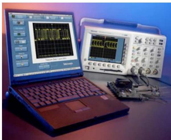
Sl. 110, Izgled korisničkog interfejsa softvera Open Choice Desktop za merenje signala pomoću osciloskopa na računaru. Prikazano je povezivanje digitalnog osciloskopa za računaru. Slika je preuzeta sa sajta Tektronix uz dozvolu (Copyright © Tektronix . Reprinted with permission. All Rights Reserved).
